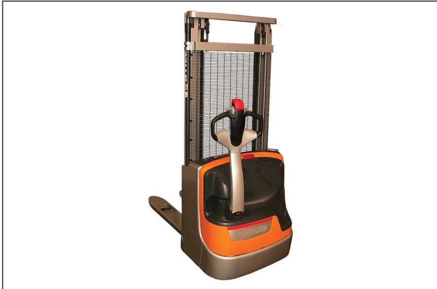
Les chariots EXV10 Basic, EXV10, EXV12 et EXV12 i, EXV14C et EXV14 iC sont conçus pour la manutention et le gerbage des palettes d'un poids maxi de 1 000 kg (EXV10 Basic et EXV10), 1 200 kg (EXV12 et EXV12 i) et 1 400 kg (EXV14C et EXV14 iC) à l'intérieur des magasins, entrepôts et usines.
