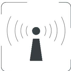
Ce symbole indique que le chariot est équipé d'un émetteur radio permettant de se connecter sans fil au site Toyota.
